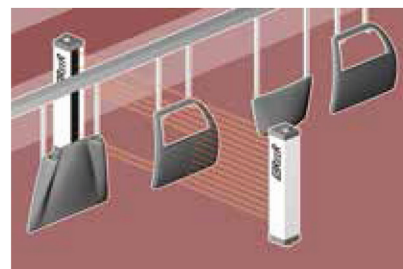
Detekce polohy a profilu dílů v automatických lakovacích systémech.
