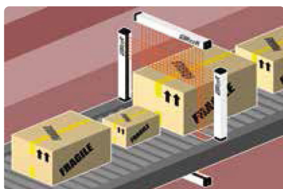
Měření výšky předmětů na dopravníkových systémech. Dvourozměrná detekce objektů na dopravníku s použitím 2 sad světelných závěsů.
