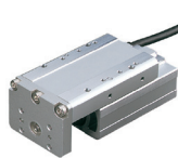
RCA2 zdvih 20 až 200 mm, rychlost až 600 mm/s, maximální zatížení (horizontální/ vertikální) až 8/4 kg
