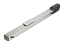
ERC3CR s integrovanou řídicí jednotkou zdvih až 800 mm rychlost až 1200 mm/s maximální zatížení (horizontální/ vertikální) až 45/25 kg
