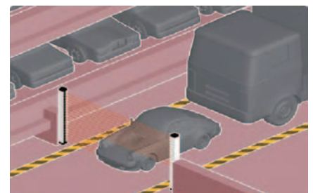
Detekce maximální výšky objektů v automatických skladech
