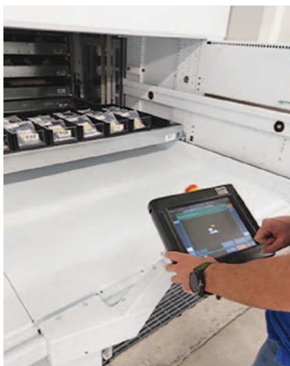
Použití vertikálního skladovacího systému za použití bezpečnostních závor EOS4 a měřících závor Micron
