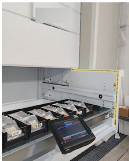
Použití vertikálního skladovacího systému za použití bezpečnostních závor EOS4 a měřících závor Micron
